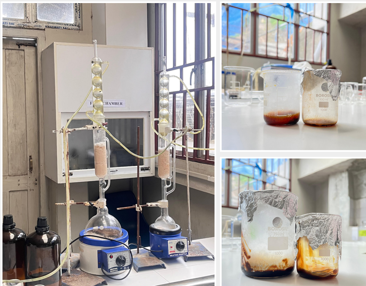
Fig. Soxhlet Apparatus setup
